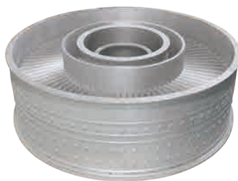
样件名称：叶轮 样件材质：316L 样件尺寸：φ1400mm*105mm 打印时间：140 小时 应用领域：航空航天
