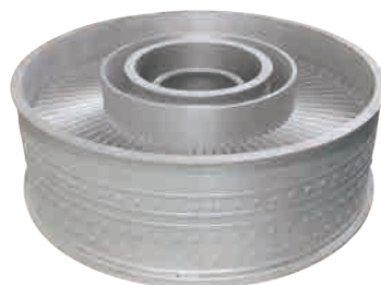
样件名称：叶轮 样件材质：316L 样件尺寸： \phi 1400\text{mm} \times 105\text{mm} 打印时间：140 小时 应用领域：航空航天
