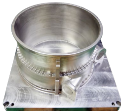
机匣 IN718 高温镍基合金 Φ500 mm*300mm
