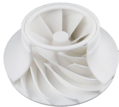
铸造用蜡模 PSB 粉末 Φ300mm*22mm
