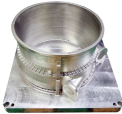
机匣 IN718 高温镍基合金 Φ500mm*300mm
