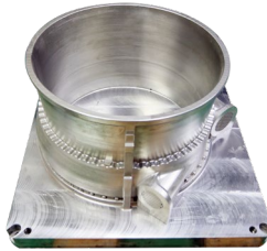
机匣 IN718 高温镍基合金 Φ500 mm*300mm
