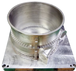
机匣 IN718 高温镍基合金 Φ500 mm*300mm
