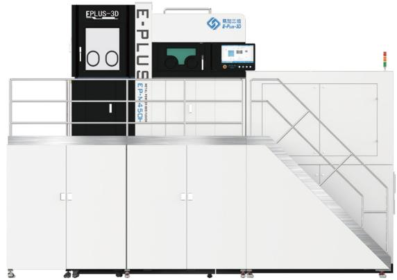
EP-M450H 采用 MPBF 金属粉末床融化技术，成型室尺寸达 456\*456\*1080mm<sup>3</sup> (Z 向高度可至 2000mm)，有单激光和双激光两种配置可选，可打印钛合金、铝合金、高温镍基合金、模具钢、不锈钢、钴铬钼合金等材料，适于航空航天、军工、模具等领域大型复杂金属结构件的直接制造。
