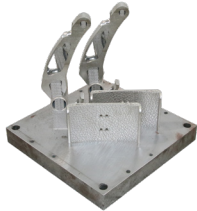
制动脚踏板 IN718 100mm*40mm*220mm
