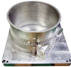
机匣 IN718 高温镍基合金 Φ500 mm*300mm
