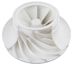
铸造用蜡模 PSB 粉末 Φ300mm*22mm
