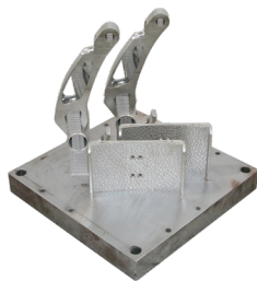
制动脚踏板 IN718 255mm*255mm*250mm
