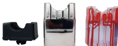
千斤顶随型水路模具 模具钢 100mm*80mm*50mm 3
